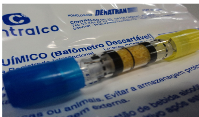
Figura 1: Modelo de um bafômetro descartável
