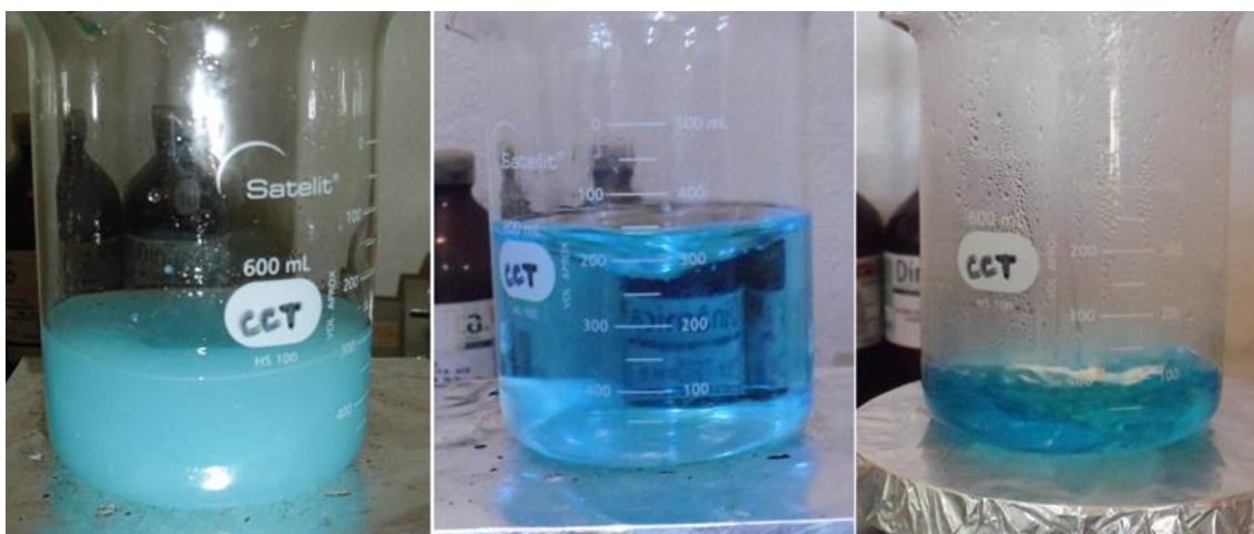
Figura 2. Sequência de preparo da solução de titanato de cálcio e cobre Ca_{0,25}Cu_{0,75}TiO_3 .
