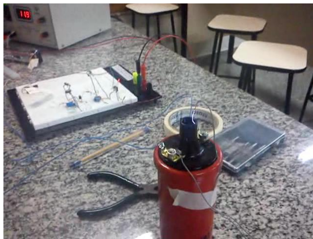
Figura 3. Montagem experimental do gerador de alta tensão em matriz de contatos.
