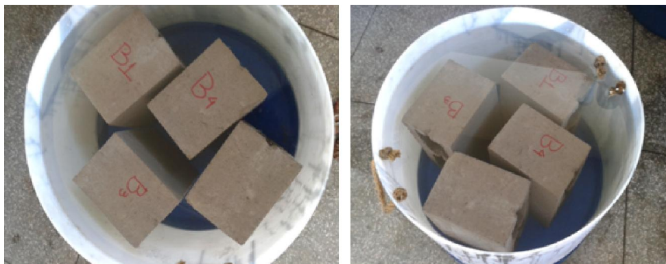
Figura 02 – Imagens do processo de cura úmida - 24 horas
