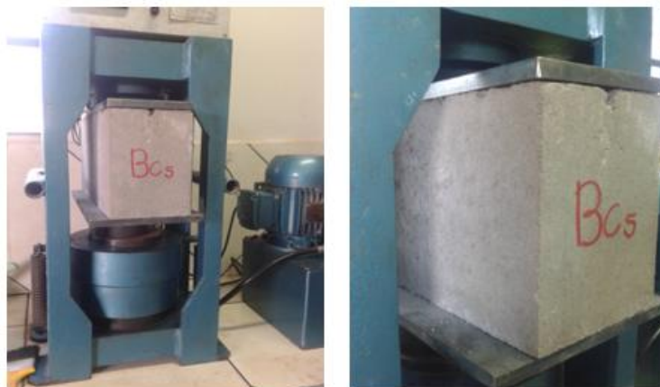
Figura 03 – Imagens do rompimento dos corpos-de-prova BP e BC
