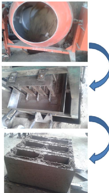
Figura 01 – Processo de conformação das amostras BP e BC
