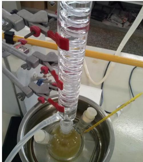
Figura 4 – Equipamento utilizado para o processamento da reação de transesterificação
