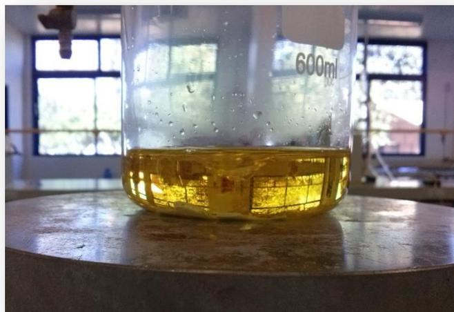
Figura 7 – Secagem do biodiesel em chapa de aquecimento
