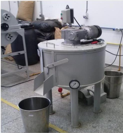
Figura 1 – Equipamento utilizado para o aquecimento das sementes
